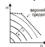
В этом режиме регуляции циркуляционный насос работает по типичным кривым с постоянной скоростью. Рабочая кривая выбирается после выбора скорости вращения посредством процентного коэффициента. Значение 100% означает кривую максимального предела. Фактическая скорость вращения может зависеть от ограничений мощности и от дифференциального давления Вашей модели циркуляционного насоса.
